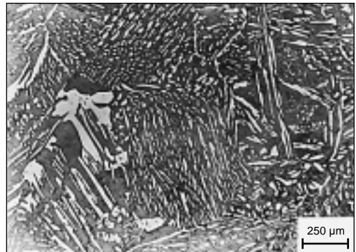
1. irudia. % 50 \alpha / % 50 \gamma duen 2205 motako altzairu herdoilgaitzaren mikroegitura urtu landugabe egoeran. % 20 potasa-disoluzioak elektroerazoz ferrita fasea ilundu egiten du. Austenita fasea argi ikusten da irudian.
