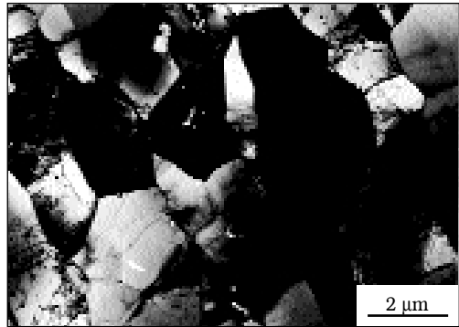
4. irudia. Azpialegi osatutako egitura A1-% 1 Mg aleazio baten kasuan (5).
